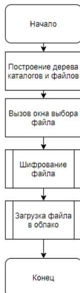
Рисунок 2 – Блок-схема модуля шифрования и загрузки файлов в облачное хранилище
