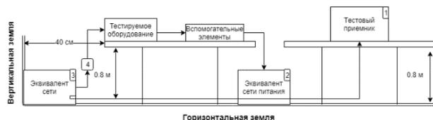
Рис.4. Эквивалентная схема стенда для исследования на кондуктивную совместимость
